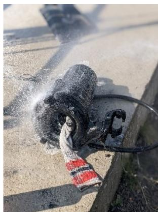
En réalité, ces articles se gorgent de graisse et d'eau pour se transformer en masses visqueuses. **Elles bloquent les conduites sanitaires, obstruent et brisent les pompes et le système de filtration de la station d'épuration et entraînent des refoulements d'égouts.** De plus, les interventions se font en milieu fermé et sont très risquées pour les employés affectés à retirer ces masses visqueuses.
